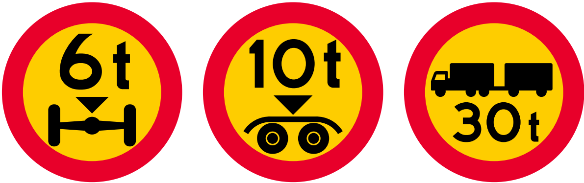
För broar längre än 6 meter är det viktigt att man får bron bärighetsklassad även för bruttovikt för fordonskombinationer, det högra trafikmärket i bilden. För kortare broar räcker det med axel- och boggitryck.
