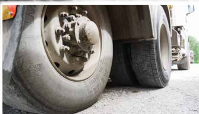
Lastbil med specialmonterade däck för packning
